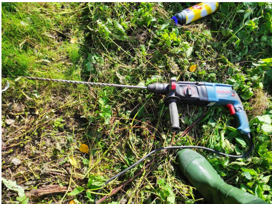
Obrázek 14 Pracovní délka vrtáku 550 mm
